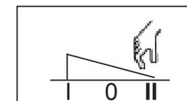
Im Störfall drücken sie den Geräteschalter auf den linken Teil der Wippe bis zum ersten Rastpunkt (Schalterstellung 0). Das Gerät ist nun komplett ausgeschaltet.
