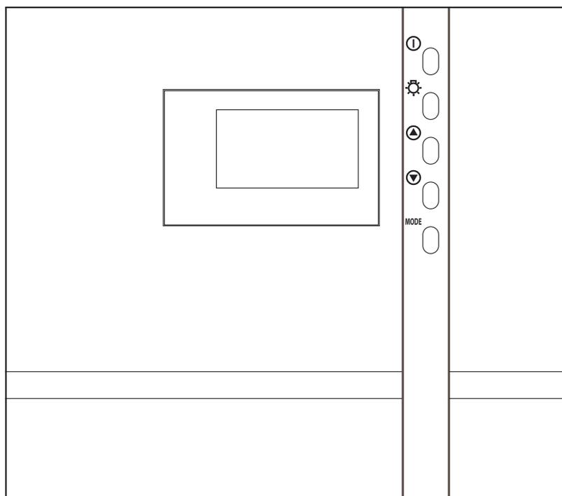
Die Abbildung zeigt das Bedienteil im Stand by - Betrieb mit eingeschaltetem Licht.
