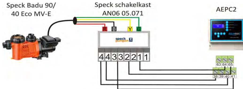
Afbeelding 15. Aansluiten Speck Badu 90/40 MV-E + Schakelkast AN06 05.071
