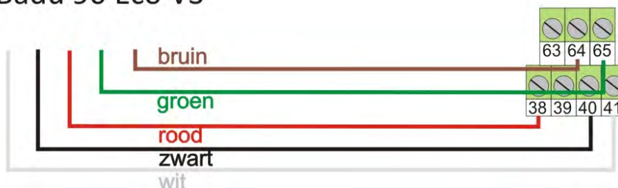
Afbeelding 14. Aansluiten Speck Eco Touch Pro, Eco Flow en Badu 90 Eco VS
